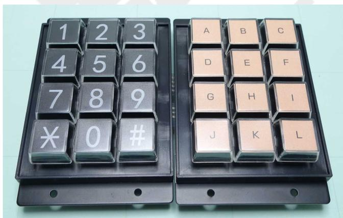
キートップ印刷文字はクリアカバーで保護されており、磨耗によって文字が消えません。また文字シートを挟み込みなどして少数よりキー表示変更が行えます。写真右側は文字シートを挟み込みしたキーボードです。
