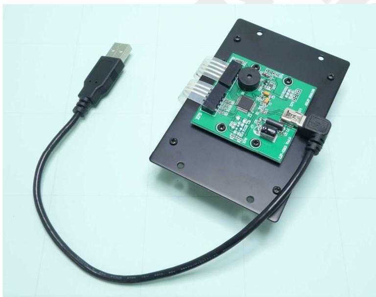
同梱されている USB ケーブルはキーボード側 miniUSB, ホスト側 USB Atype の 30cm ケーブルです。キーボードに接続して専用ケーブルとしてご使用ください。
