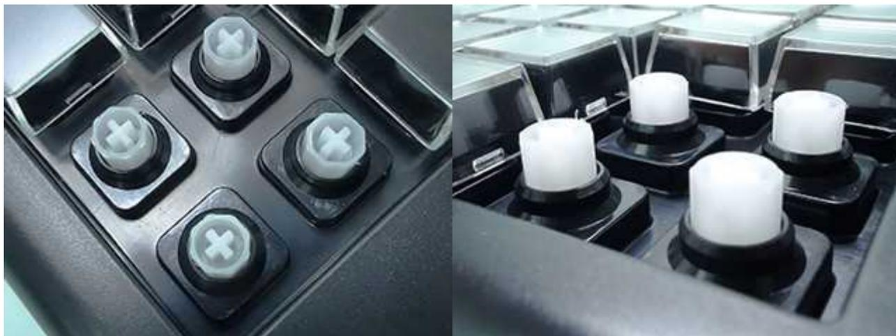
キートップ下のフレームは突起状に盛り上がっており、キーステム部の隙間より埃や水を進入しづらい構造になっています。
