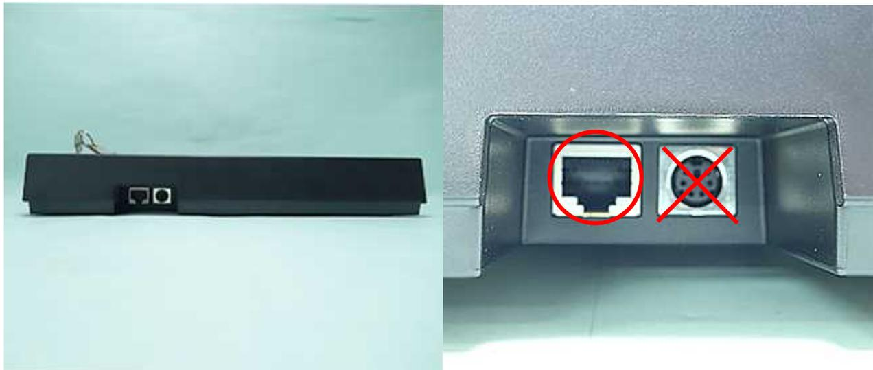
キーボード背面には専用 USB ケーブルを差し込むモジュラーjack と PS/2 ポートがあります。モジュラーjack へ専用 USB ケーブルを接続して使用します。PS/2 ポートは使用しません。
