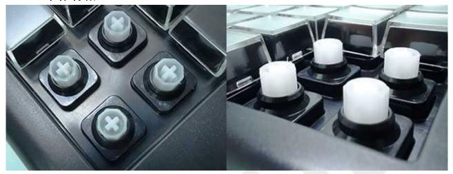
キートップ下のフレームは突起状に盛り上がっており、キーステム部の隙間より埃や水を進入しづらい構造になっています。
