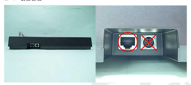
キーボード背面には専用 USB ケーブルを差し込むモジュラージャックと PS/2 ポートがあります。モジュラージャックへ専用 USB ケーブルを接続して使用します。PS/2 ポートは使用しません。
